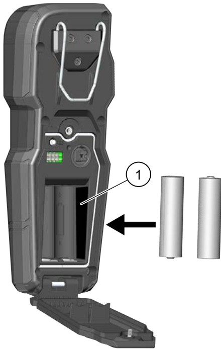
ilustracja 1. Montaż baterii pilota zdalnego sterowania
