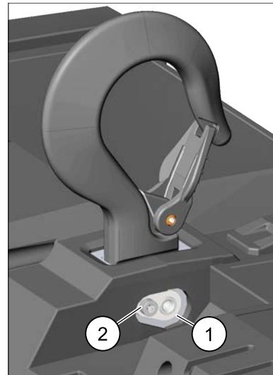
Ábra 7. Felfüggesztő csap rögzítője/Rögzítő csavar
