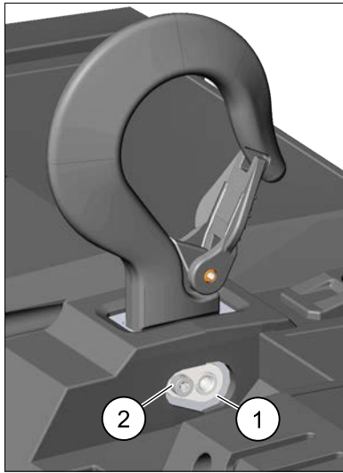
Figura 7. Fermo del perno di sospensione/vite di tenuta
