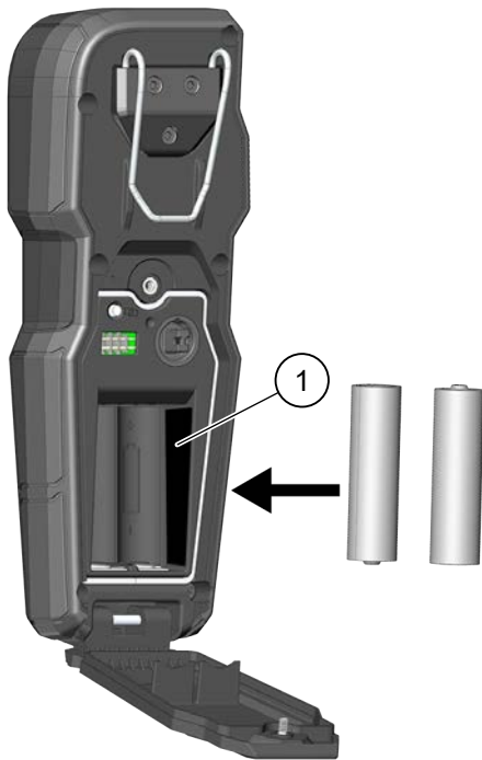
Afbeelding 1. Batterijen van de afstandsbediening plaatsen
