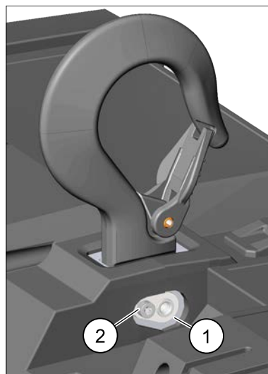
Afbeelding 7. Borgpen voor ophanging/Bevestigingsschroef
