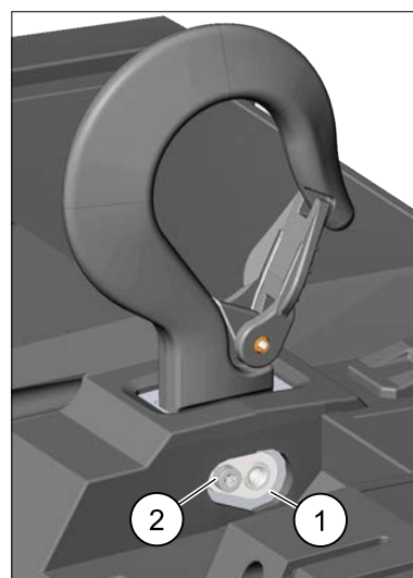
ilustracja 7. Element ustalający sworznia zawieszenia/śruba ustalająca
