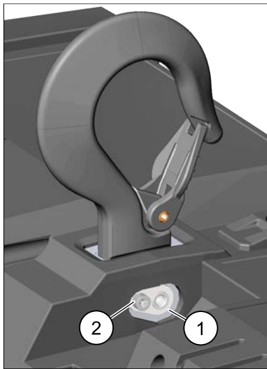
Abbildung 7. Halterung des Aufhängungsbolzens/Befestigungsschraube
