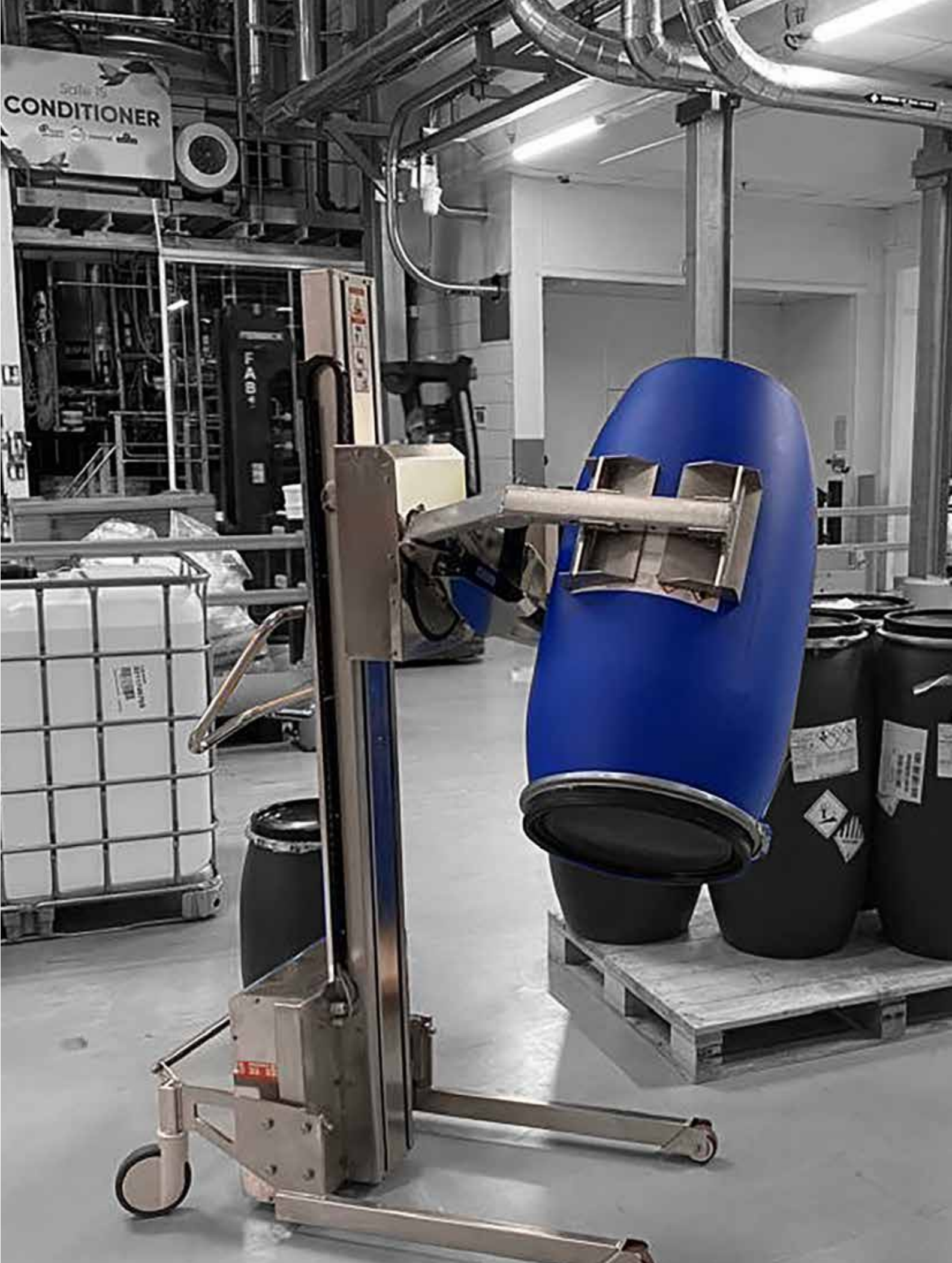
Chariot R.205 SS avec pince électrique avec bloc de rotation
