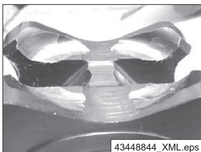
Fig. 48 Exemple : usure de la noix de la chaîne
