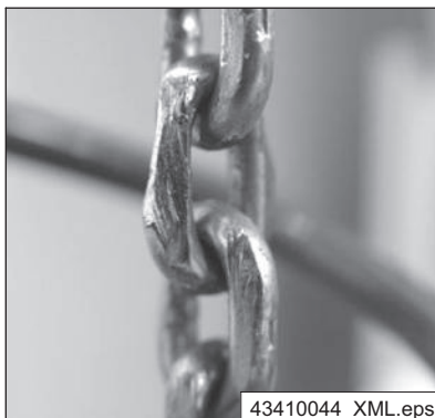
Fig. 52 Exemple : Usure de la chaîne
