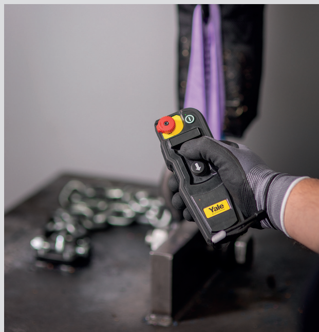
La vitesse progressive permet un positionnement précis de la charge.
